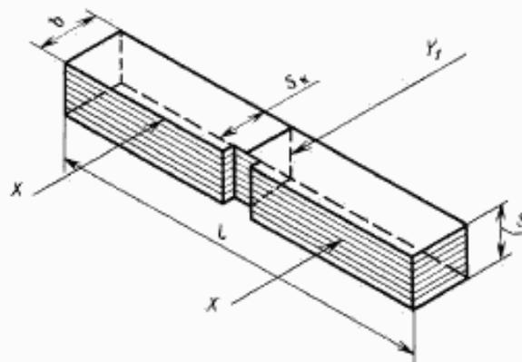
X — направление расположения опор; Y<sub>1</sub> — направление удара параллельно слоям
