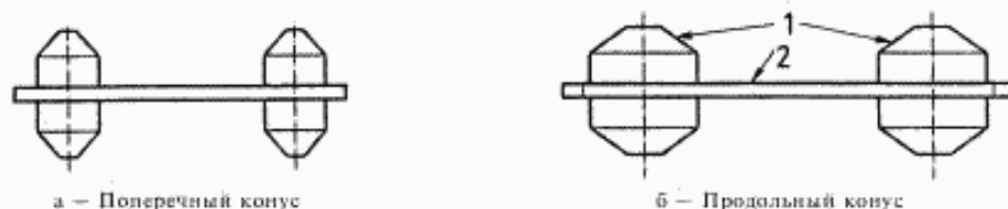
1 — конус; 2 — промежуточная пластина
