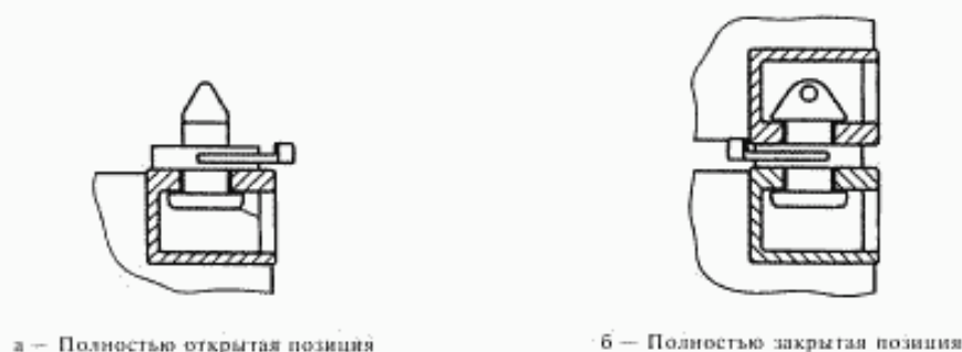
Рисунок А.1 — Ручной стопор двухпозиционный с фиксированным основанием и одной поворотной головкой
