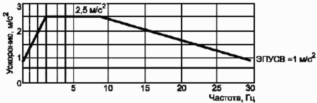
Рисунок 1 — Зависимость между максимальной амплитудой ускорения и частотой синусоидальной вибрации (спектр воздействия) для горизонтального направления 9 баллов в соответствии с [1] или [2] при нулевой отметке
