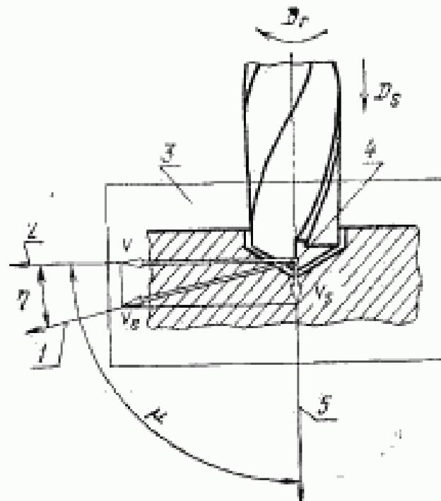
1—направление скорости результирующего движения резания; 2—направление скорости главного движения резания; 3—рабочая плоскость  $P_s$ ; 4—рассматриваемая точка режущей кромки; 5—направление скорости движения подачи
