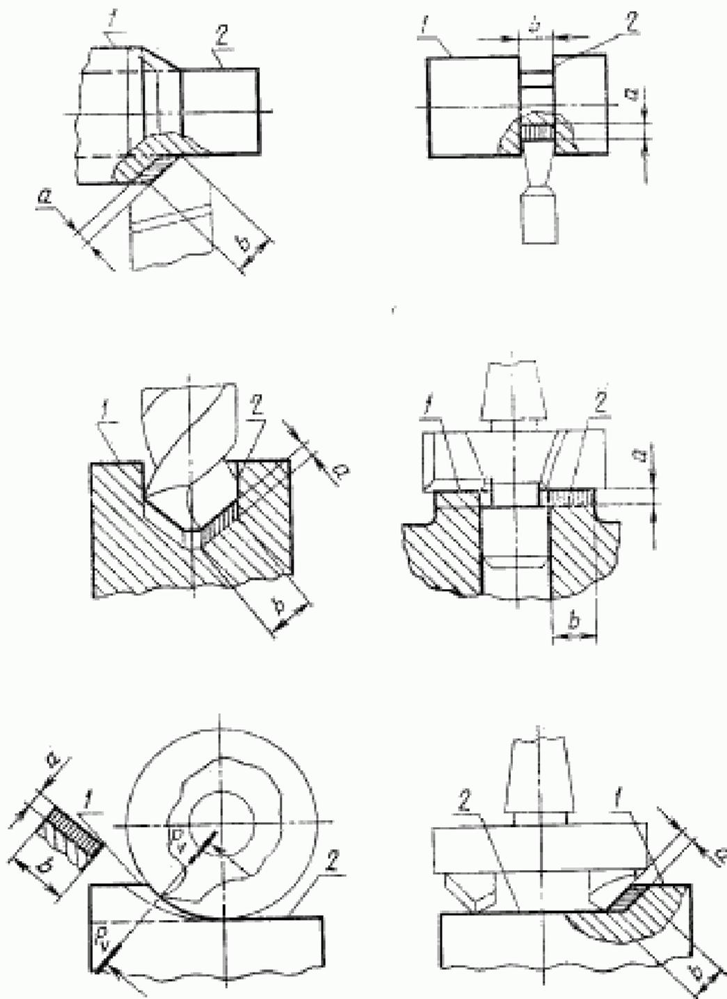
1—обрабатываемая поверхность; 2—обрабатывающая поверхность
