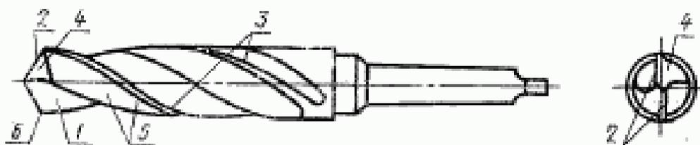
1—передняя поверхность лезвия;  $A_{\gamma}$ ; 2—главная режущая кромка  $K$ ;
