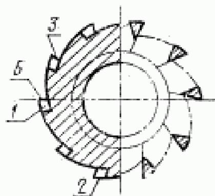
1—передняя поверхность лезвия  $A_1$ ; 2—главная режущая кромка  $K$ ; 3—вспомогательная режущая кромка  $K'$ ; 4—главная задняя поверхность лезвия  $A_2$ ; 5—вспомогательная задняя поверхность лезвия  $A_2'$ ; 6—вершина лезвия
