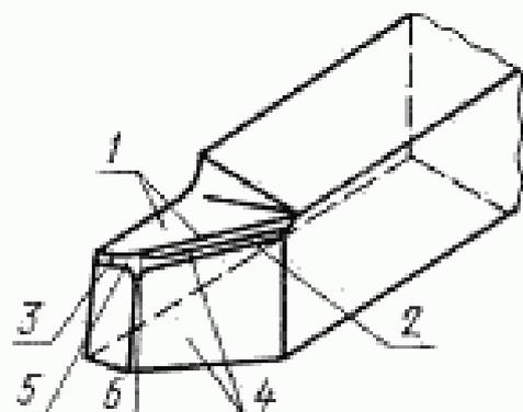
1—передняя поверхность лезвия  $A_1$ ; 2—главная режущая кромка  $K$ ; 3—вспомогательная режущая кромка  $K'$ ; 4—главная задняя поверхность лезвия  $A_2$ ; 5—вспомогательная задняя поверхность лезвия  $A_2'$ ; 6—вершина лезвия
