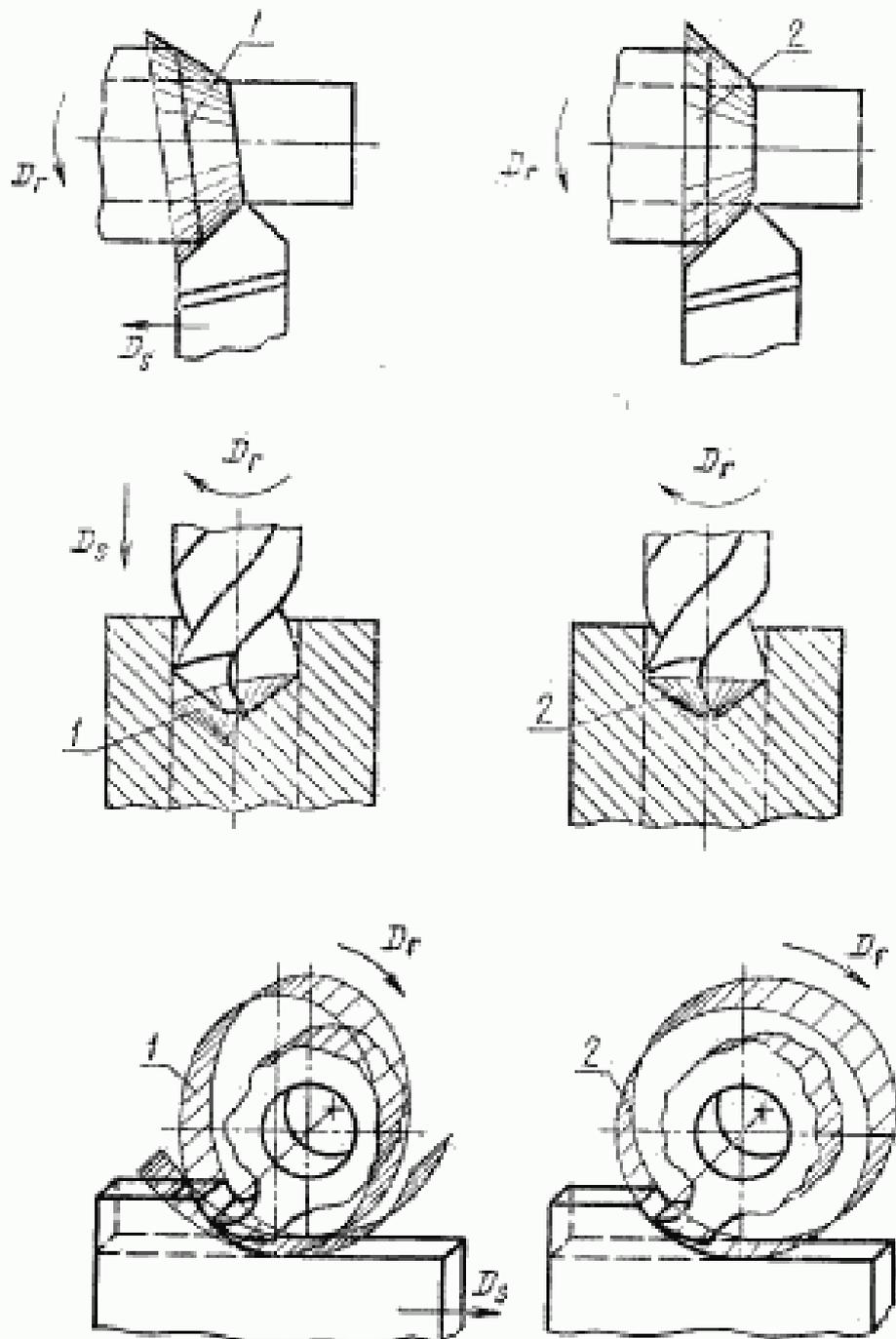
1—поверхность резания  $R$ ; 2—поверхность главного движения  $R_r$
