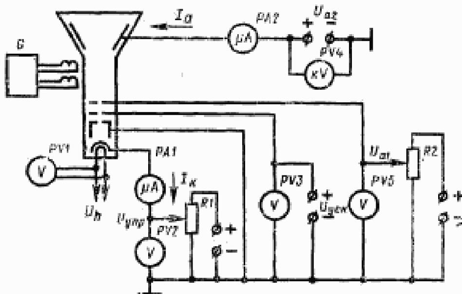
$U_{a1}$ —источник напряжения первого анода (фокусирующего электрода);  $U_{a2}$ —источник напряжения второго анода;  $U_{уск}$ —источник напряжения ускоряющего электрода;  $U_{упр}$ —источник напряжения управляющего электрода (катода);  $U_h$ —источник напряжения накала;  $G$ —генератор развертывающих токов;  $PA1, PA2$ —микроамперметры;  $PV1-PV5$ —вольтметры (киловольтметры);  $R1, R2$ —регулирующие резисторы
