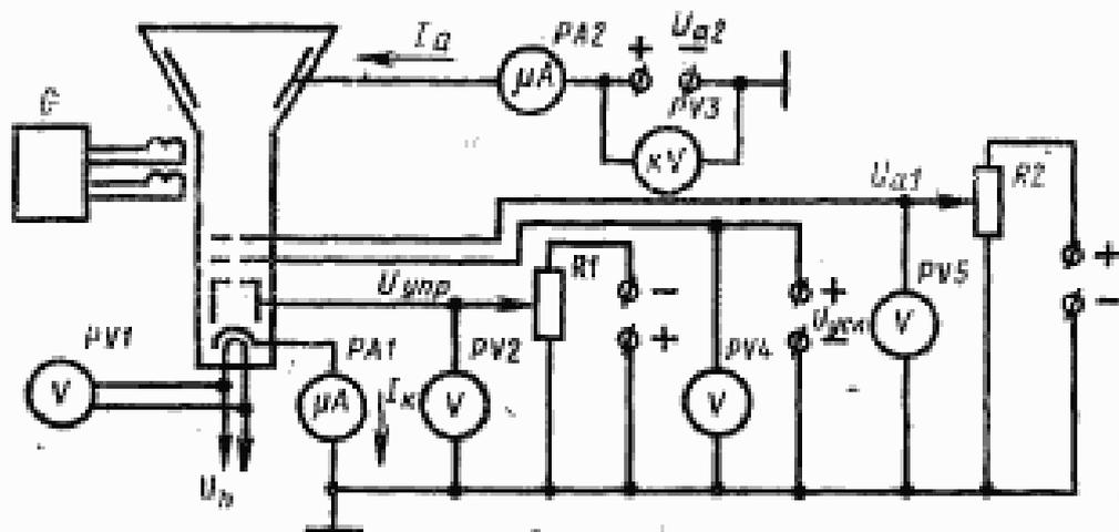
$U_{a1}$ —источник напряжения первого анода (фокусирующего электрода);  $U_{a2}$ —источник напряжения второго анода;  $U_{уск}$ —источник напряжения ускоряющего электрода;  $U_{упр}$ —источник напряжения управляющего электрода (модулятора);  $U_h$ —источник напряжения накала;  $G$ —генератор развертывающих токов;  $PA1, PA2$ —микроамперметры;  $PV1-PV5$ —вольтметры (киловольтметры);  $R1, R2$ —регулирующие резисторы
