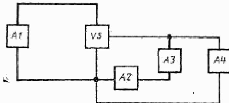
*A1*—устройство задания режима в цепи основных выводов тиристора; *VS*—испытываемый тиристор; *A2*—измерительное устройство для измерения неотпирающего (постоянного или импульсного) тока управления; *A3*—устройство задания режима в цепи управления; *A4*—измерительное устройство для измерения неотпирающего постоянного или импульсного напряжения управления.
