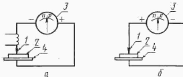
1 — зонд; 2 — образец; 3 — нуль-индикатор; 4 — металлическая пластинка
