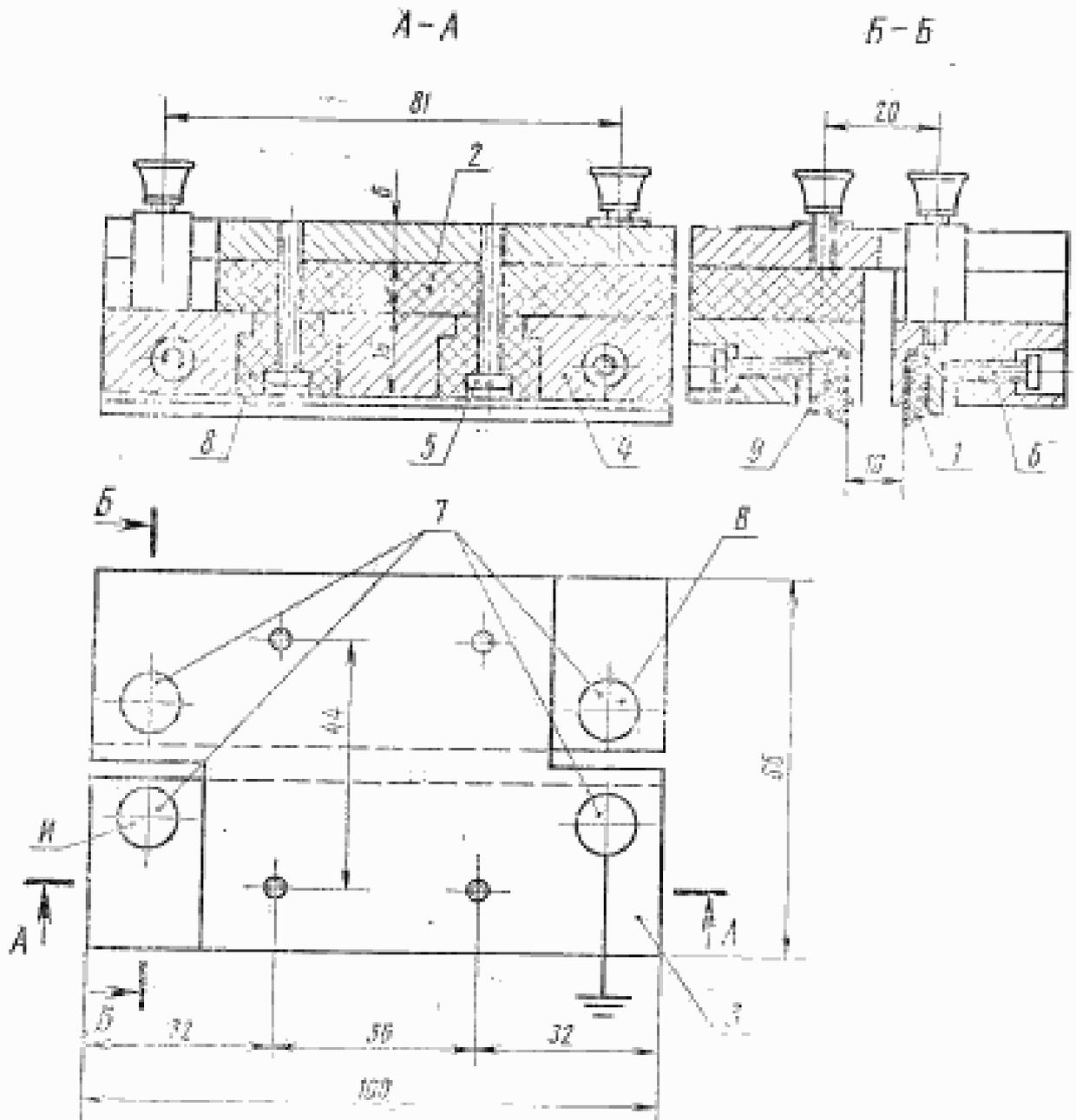
1—покрытые электроды (резина, обернутая фольгой); 2—прокладна; 3—основание; 4—электродные бруски; 5—отверстия для кристаллов; 6—прижимные ленты; 7—зажимы; 8—штулки; 9—плашки прижимные; 10—электрод напряжения; 11—измерительный электрод
