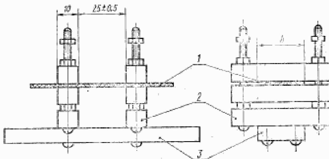
1—образец; 2—изоляция; 3—металлическая пластина.
