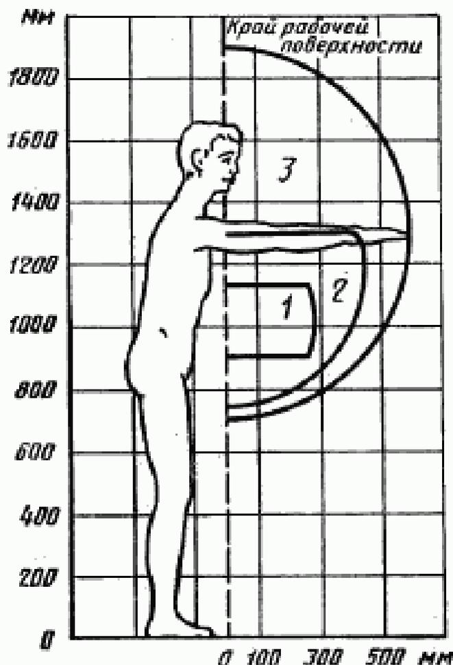
1 — зона для размещения очень часто используемых и наиболее важных органов управления (оптимальная зона моторного поля); 2 — зона для размещения часто используемых органов управления (зона легкой досягаемости моторного поля); 3 — зона для размещения редко используемых органов управления (зона досягаемости моторного поля)
