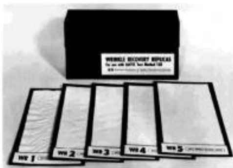
Рисунок 2 — Реплики восстановления прежней формы после сминания
