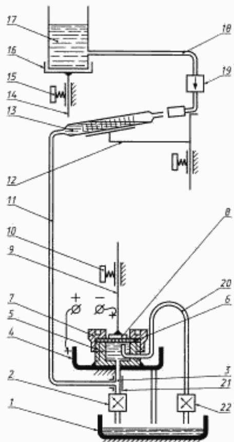
Прибор обеспечивает отсчет времени промокания образца, световую и звуковую сигнализацию в момент его промокания.
