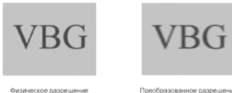
Рисунок 1 — Буквы, отображенные на экране дисплея с физическим и преобразованным разрешениями
