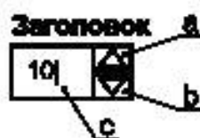
a — кнопка инкремента; b — кнопка декремента; c — панель вывода значений
