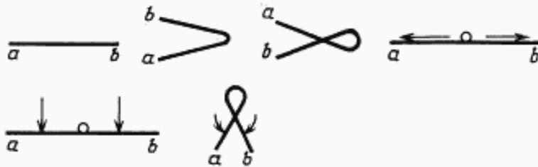
4.8. Для проверки проволоки на хрупкость из проверяемого образца делают петлю и ветви этой петли растягивают до образования прямой линии и, не выворачивая образованной петли, ветви ее сближают в направлении, противоположном растягиванию, до сближения ветвей (чертеж).
