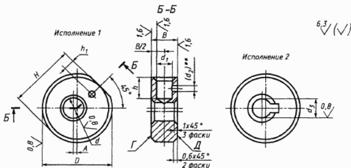
\*\* Размер в скобках — после сборки. Отверстие под штифт развернуть с полем допуска K7.
