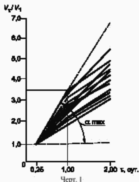
Результаты испытаний, полученные по количеству водорода, выделившегося при 6-часовых испытаниях, приводят к результатам 2-суточных испытаний по формуле
