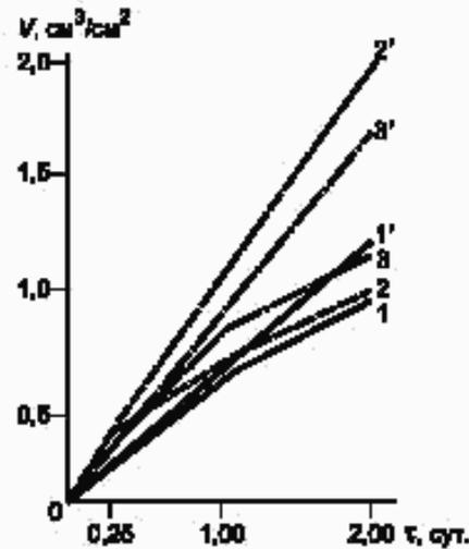
1, 2, 3 — кривые зависимости  $V = f(t)$  при 48-часовых испытаниях; 1', 2', 3' — кривые зависимости  $V = f(t)$  при 6-часовых испытаниях
