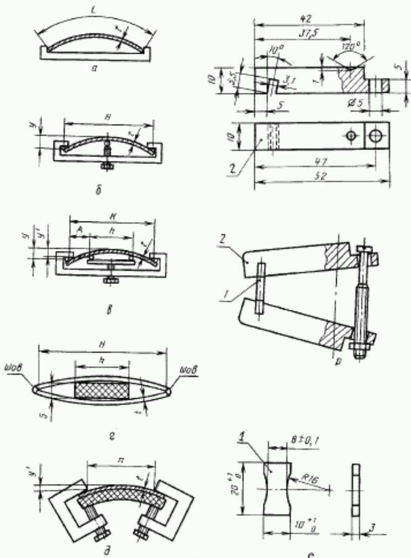
*a* — образец, нагруженный в двух точках; *б* — образец, нагруженный в трех точках; *в* — образец, нагруженный в четырех точках; *г* — образец в виде двойного бруса; *д* — образец на сплошной опоре; *е* — образец, нагруженный с помощью рычага;
