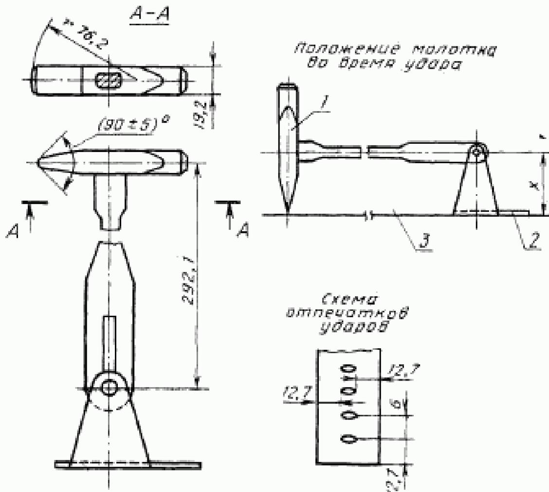
1—молот; 2—прижимная плита; 3—поверхность образца; x—размер, определяемый опытным путем в зависимости от металла, на которого изготовлена головка молотка
