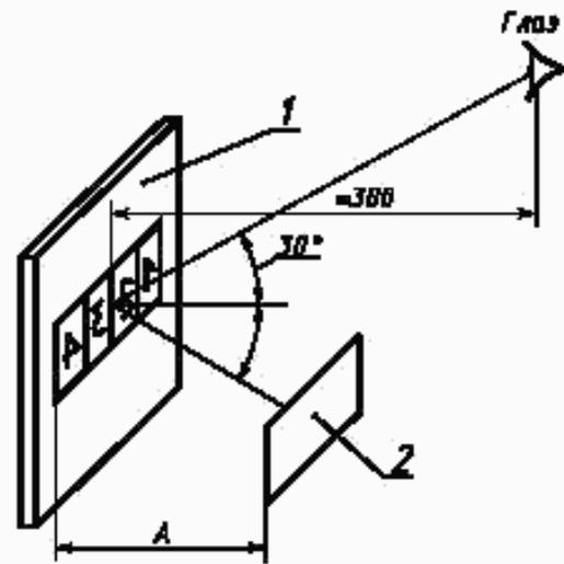
1 — образец; 2 — пластина с сеткой или рисунком; А — максимальное расстояние, при котором сетка или рисунок четко отражается на поверхности покрытия
