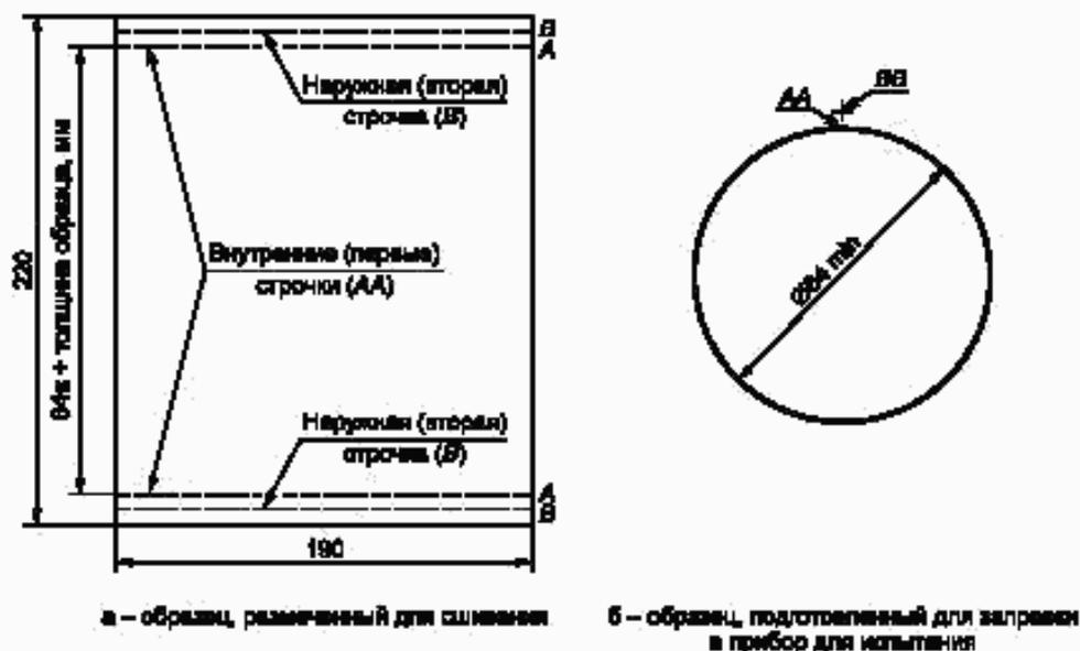
Рисунок 1.4 — Форма образца для испытания на скручивание/изгиб
