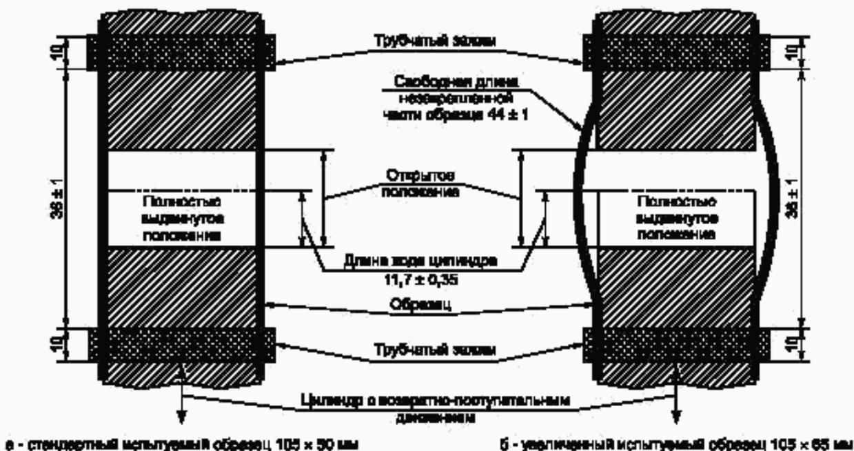
Рисунок 1.2 — Схема заправки образцов для испытания
