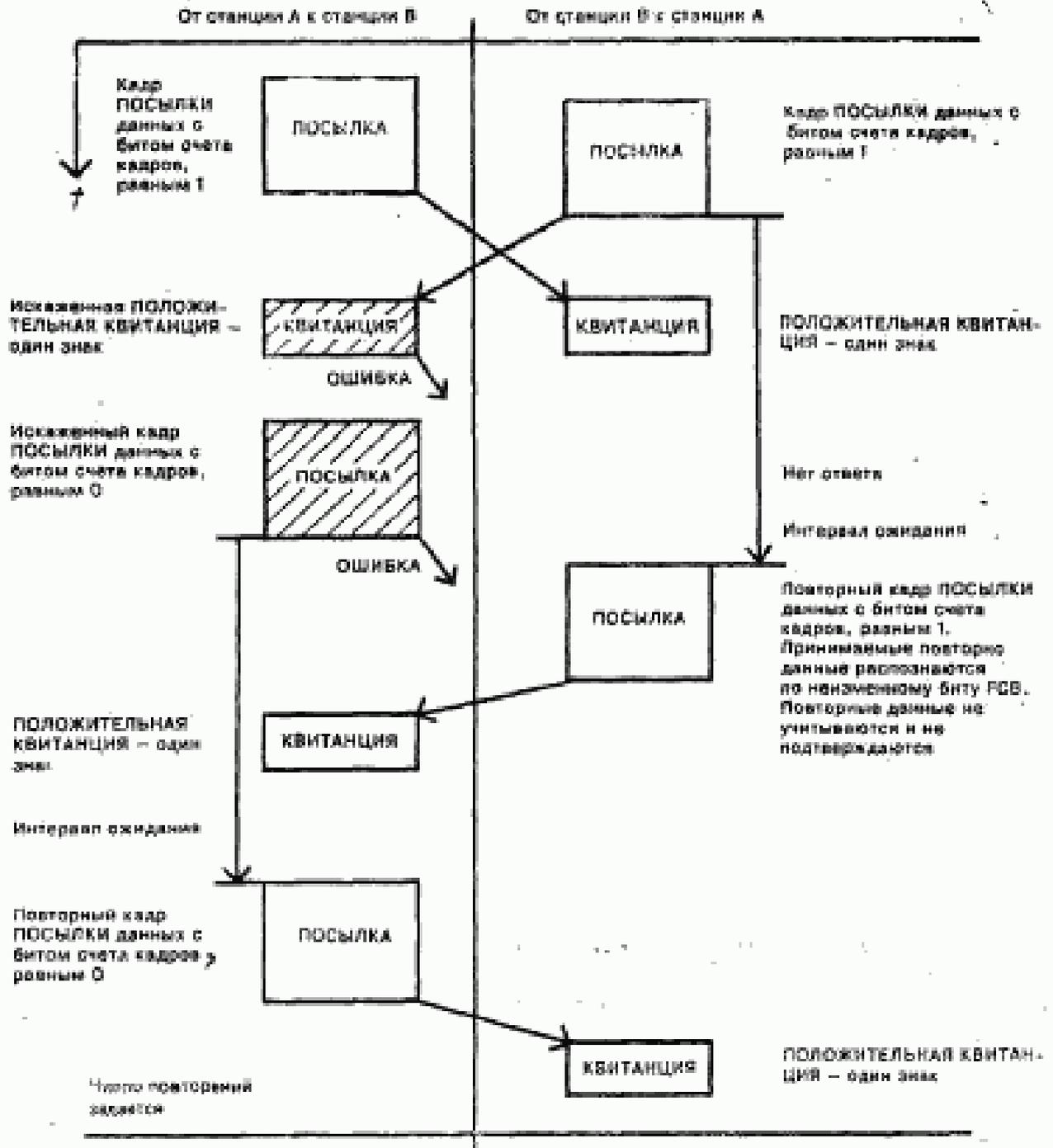
Рисунок 16 — Балансные процедуры передачи. Ненесправен канал связи в одном направлении
