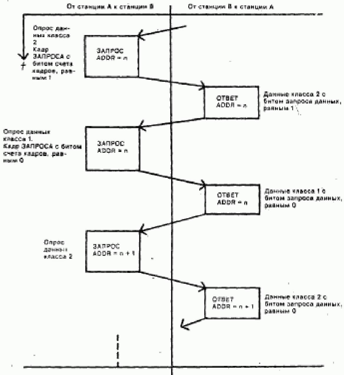
Рисунок 7 — Небалансные процедуры передачи, неискаженные процедуры ЗАПРОС/ОТВЕТ
