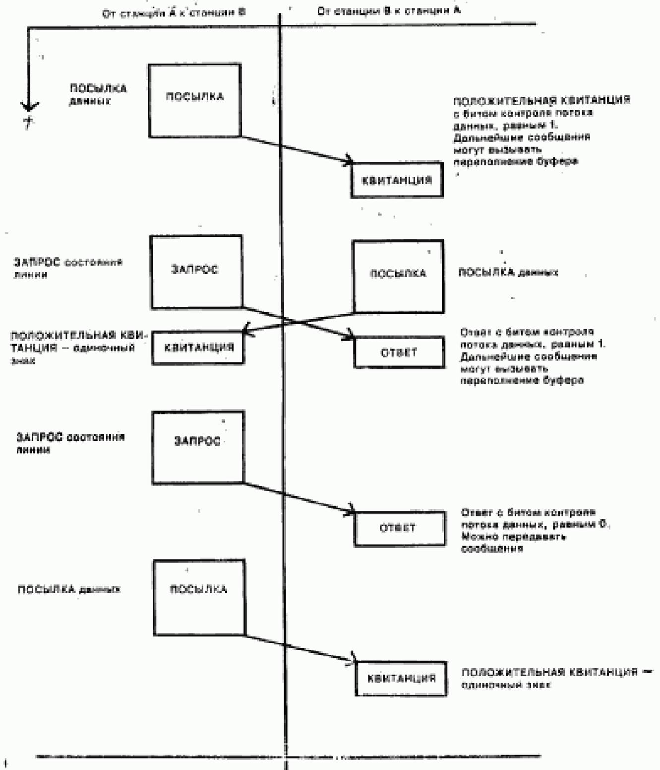
Рисунок 12 — Балансные процедуры передачи. Контроль потока данных
