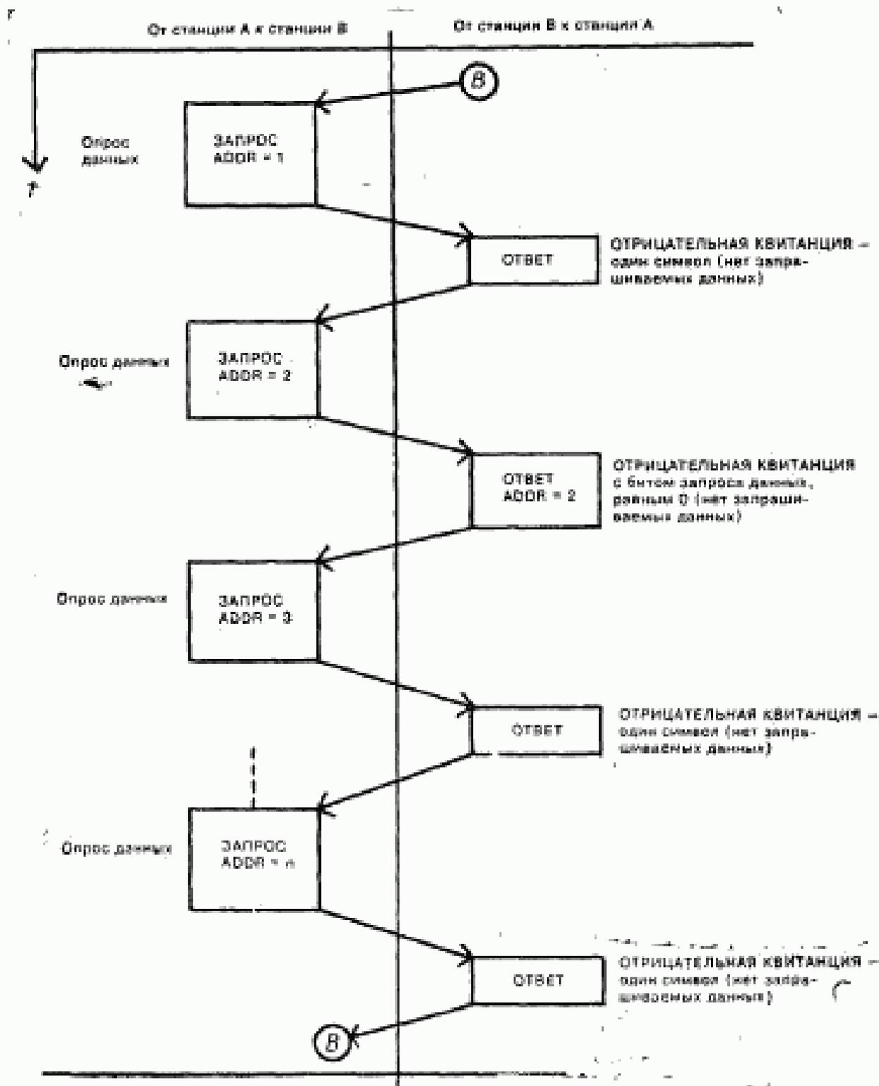
Рисунок 5 — Небалансные процедуры передачи, неискаженные процедуры ЗАПРОС/ОТВЕТ
