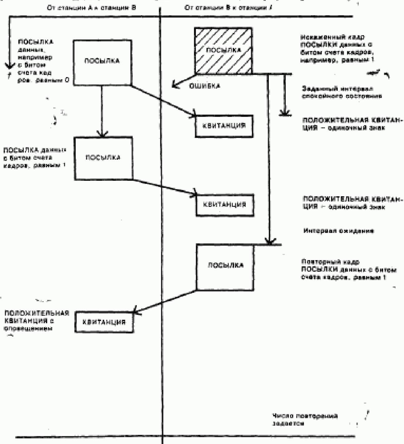
Рисунок 13 — Балансные процедуры передачи. Искаженный кадр ПОСЫЛКИ
