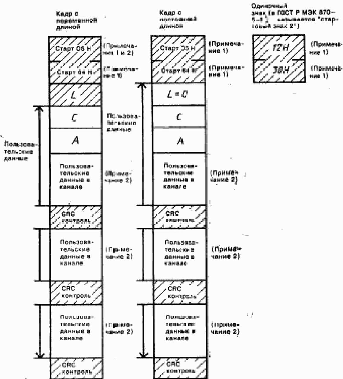
L — поле длины в пределах 0...255. L определяет число последующих байтов пользовательских данных, включая поле управления и адресное поле и исключая байты CRC контроля; L=0 определяет кадр фиксированной длины с минимум двумя байтами пользовательских данных; L>0 определяет кадр переменной длины с L байт пользовательских данных; C — поле управления; A — адресное поле (необязательно); CRC — check — контрольные разряды циклического кода.
