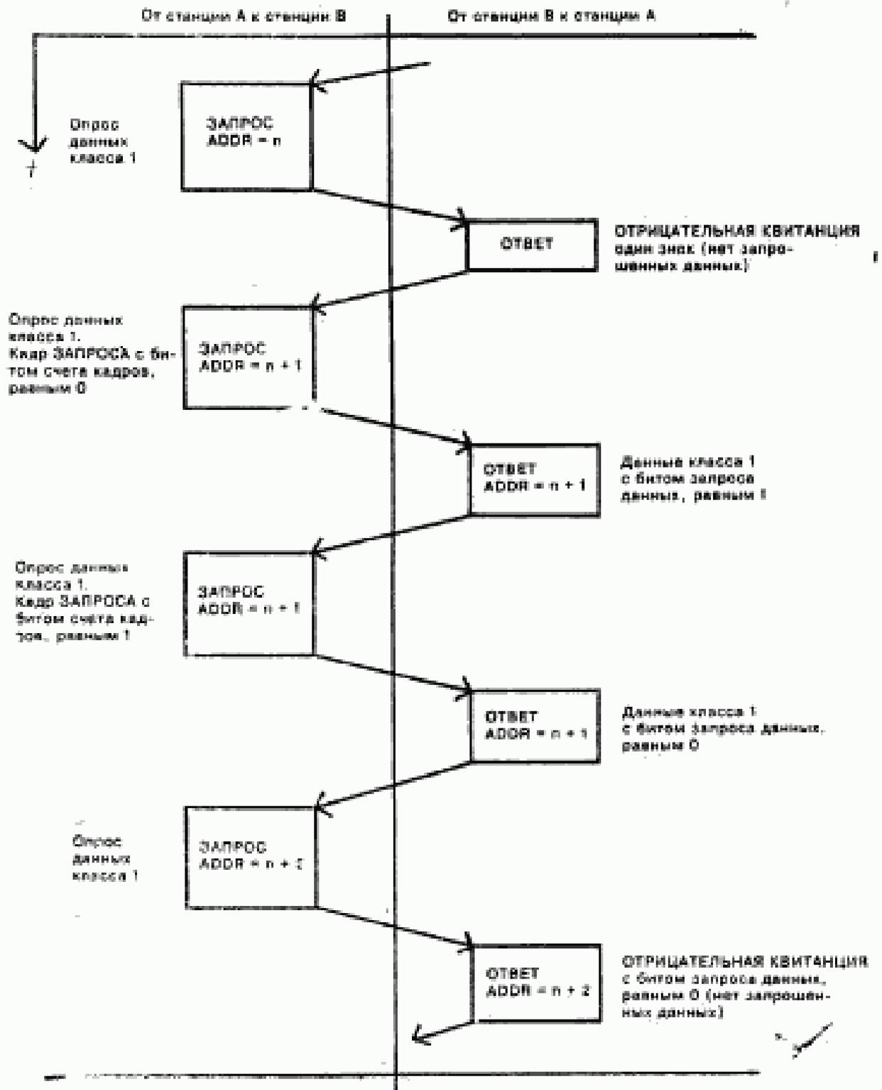
Рисунок 6 — Небалансные процедуры передачи, неискаженные процедуры ЗАПРОС/ОТВЕТ
