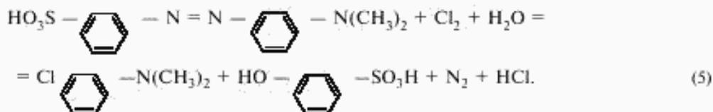
В результате окисления метилового оранжевого окраска его растворов становится менее интенсивной. Интенсивность окраски зависит от порядка смешивания растворов, поэтому анализируемую соляную кислоту добавляют последней при перемешивании. Метод отличается избирательностью, железо (III) мешает определению. Диапазон измерения  $5 \cdot 10^{-4} - 8 \cdot 10^{-3}$  %.
