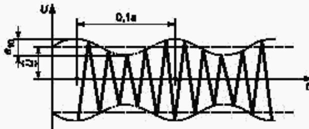
Рисунок 6 — Синусоидальная модуляция напряжения амплитудой  $U_0$  и регулярной частотой 10 Гц
