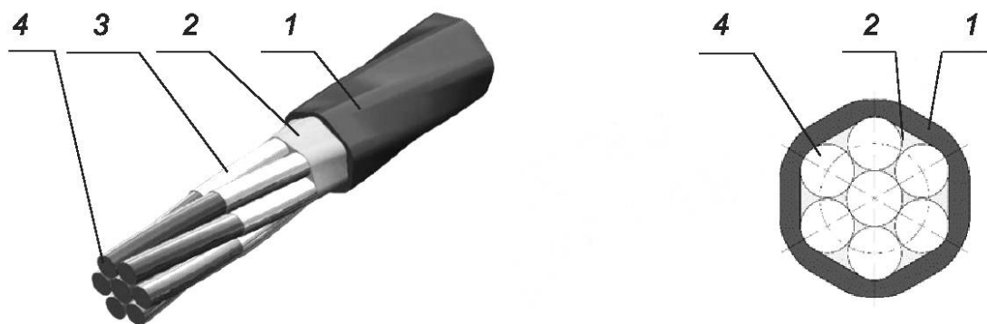
1 — индивидуальная оболочка; 2 — защитная смазка или парафин; 3 — защитное покрытие проволок цинком или цинковым сплавом Zn95Al5; 4 — стальной канат типа К7
