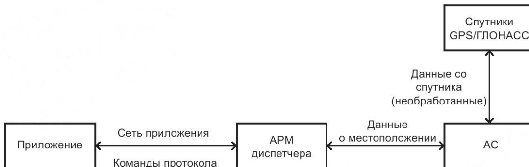
Рисунок Г.1 — Процесс запроса и получения данных о местоположении в комплексе стандартов на цифровую профессиональную подвижную радиосвязь
