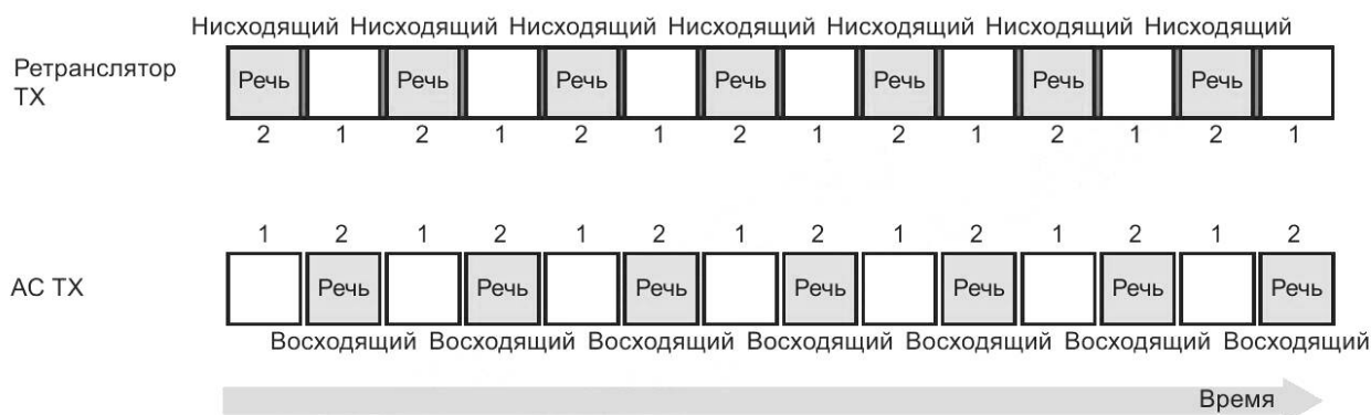
Рисунок 25 — Временные параметры речи TDD
