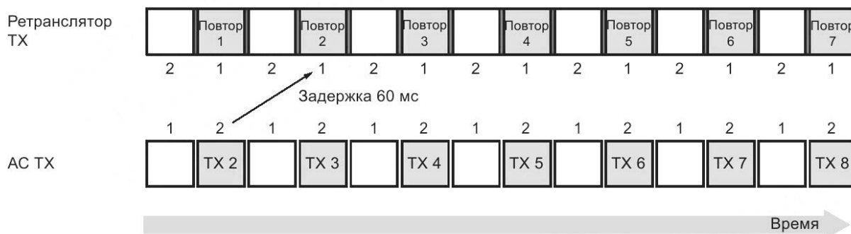
Рисунок 21 — Временные параметры выровненных каналов ретранслятора
