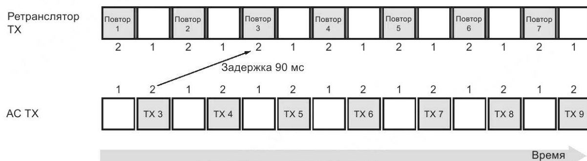
Рисунок 23 — Временные зависимости речевых ретранслированных смещенных каналов с задержкой 90 мс
