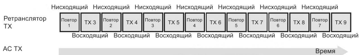
Рисунок 24 — Временные параметры одночастотного ретранслятора
