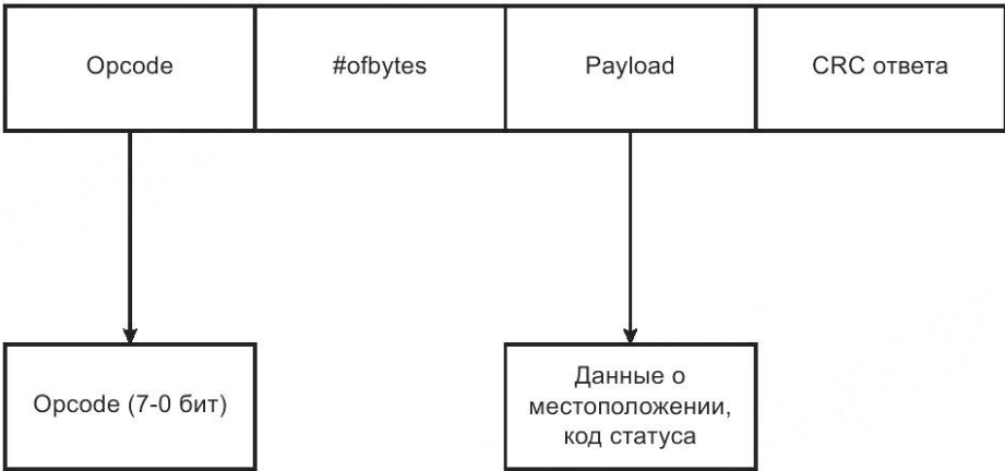
Рисунок Г.6 — Схема пакета данных ответа
