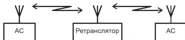
Рисунок 1 — Структурная схема организации подвижной радиосвязи с использованием ретрансляторов сигналов
