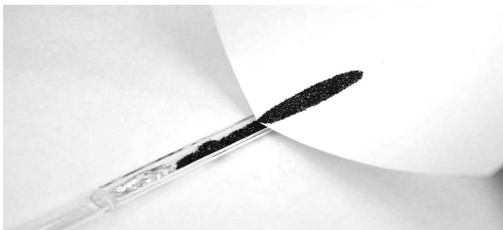
Рисунок Д.4 — Перенос сорбента в дозатор
