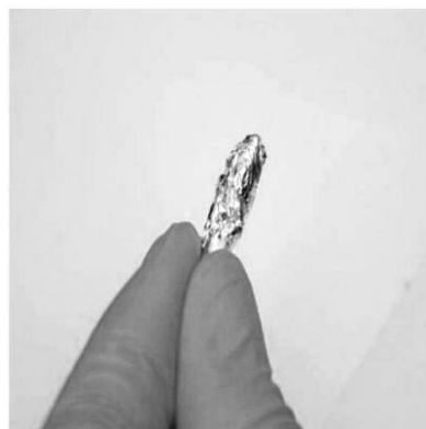
Рисунок Д.3 — Подготовка к анализу стекловолоконной перегородки
