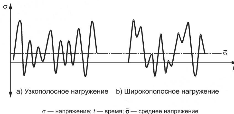
Рисунок С.9 — График узкополосного (а) и широкополосного (б) нагружения
