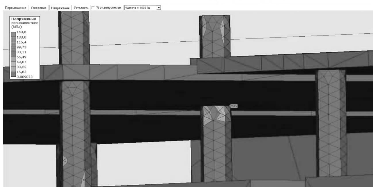
Рисунок А.8 — Эквивалентные механические напряжения во всех точках конструкции блока ЭА на резонансной частоте
