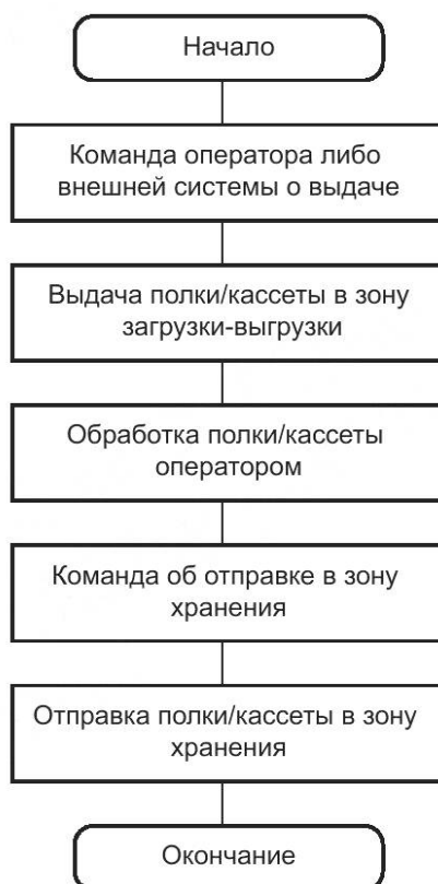
Рисунок 2 — Характерный цикл выдачи полки/кассеты
