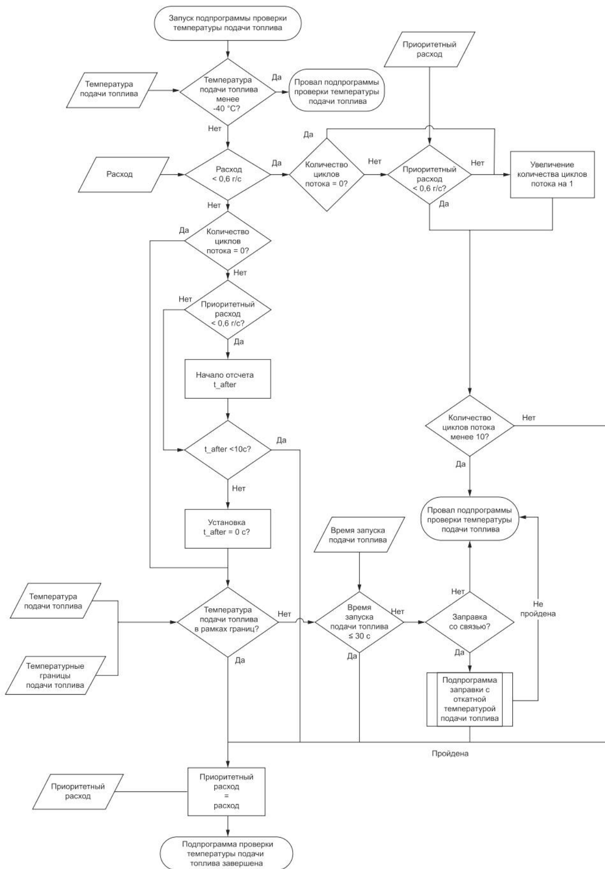
Рисунок Б.8 — Подпрограмма проверки температуры подачи водорода
