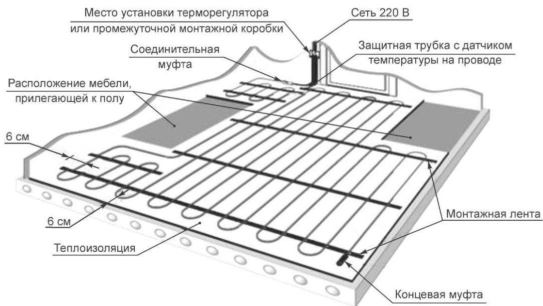
Рисунок Г.2 — Схема укладки кабельной нагревательной секции в помещении
