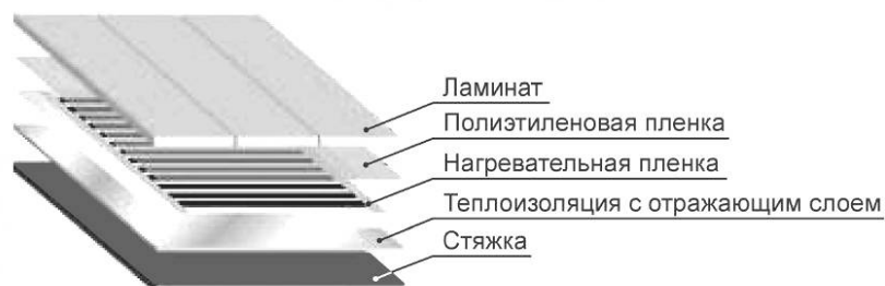
Рисунок Е.3 — Слои пола при установке нагревательной секции на основе нагревательной пленки
