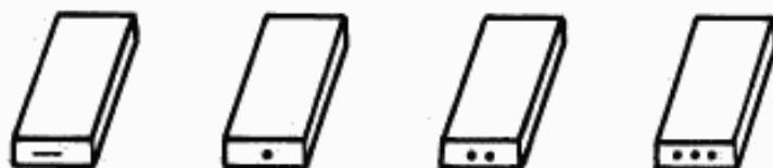
Маркировка на одном из торцов для пиломатериалов и заготовок толщиной менее 25 мм
