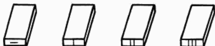
**МАРКИРОВКА ПИЛОМАТЕРИАЛОВ (ВКЛЮЧАЯ БРУСЬЯ) И ЗАГОТОВОК МЕЛКОМ НА ПЛАСТИ**
