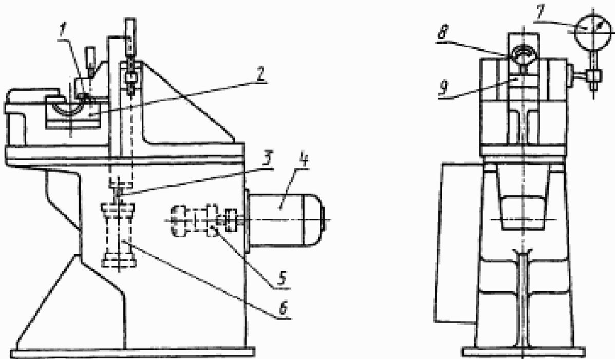
1 — самоустанавливающаяся опорная база; 2 — контрольный блок; 3 — клапан регулирования давления; 4 — приводной двигатель; 5 — масляный насос; 6 — рабочий цилиндр; 7 — манометр; 8 — индикатор; 9 — подвижная измерительная головка
