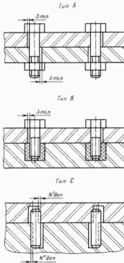
А — зазоры для прохода крепежных деталей предусмотрены в обеих соединяемых деталях. К типу А относятся, например, соединения болтами.
