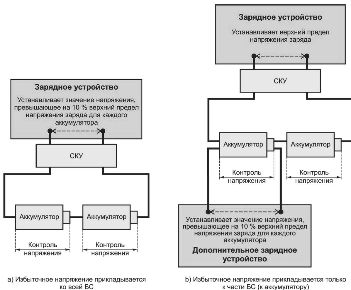
Рисунок 7 — Пример конфигурации схемы управления напряжением при перезаряде
