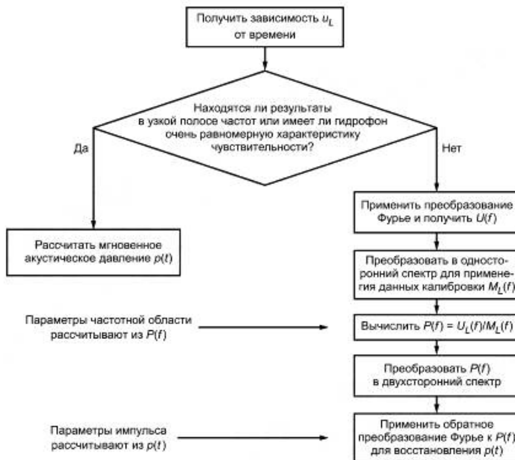
Рисунок D.1 — Блок-схема обработки результатов гидрофонных измерений методом обратной свертки
