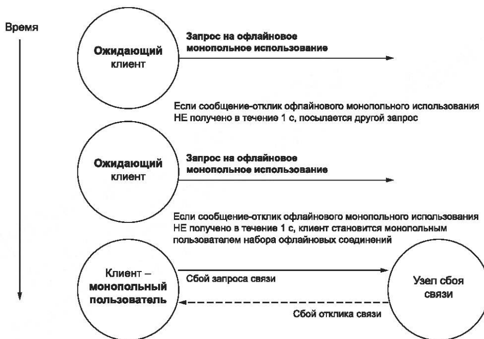
Рисунок 21 — Установление офлайн-ового монопольного использования
