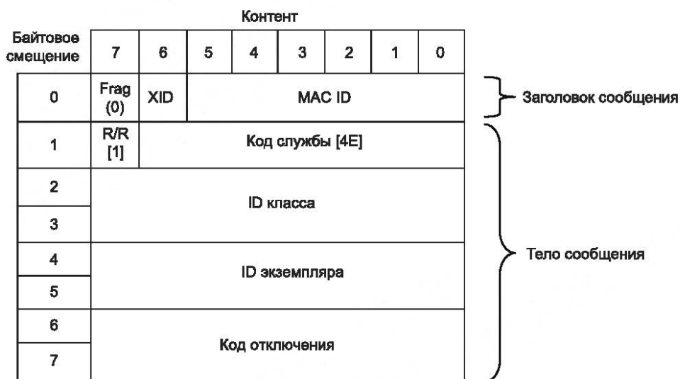
Рисунок 34 — Сообщение об отключении устройства
