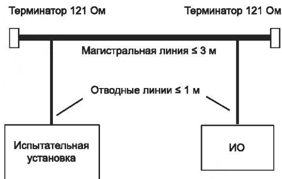
Рисунок 73 — Испытательная цепь для логических испытаний
