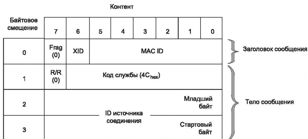
Рисунок 10 — Формат запроса на отключение соединения
