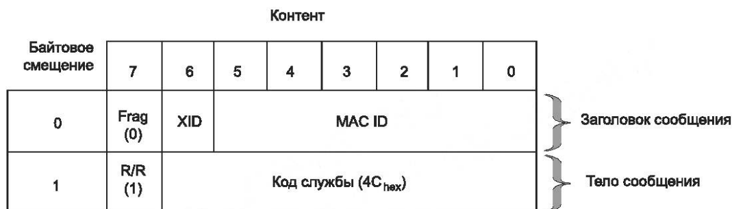
Рисунок 11 — Формат отклика на отключение соединения
