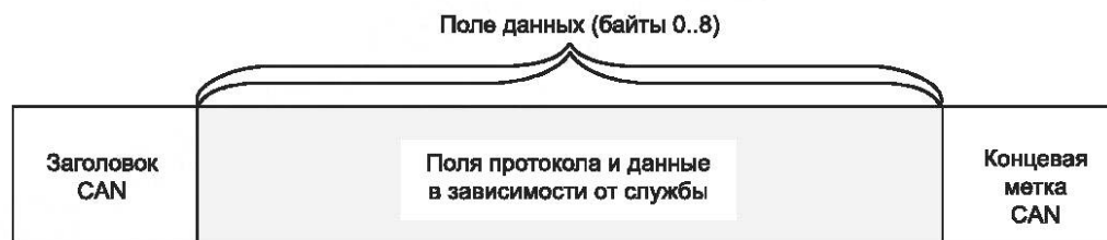
Рисунок 4 — Использование поля данных явного сообщения CAN
