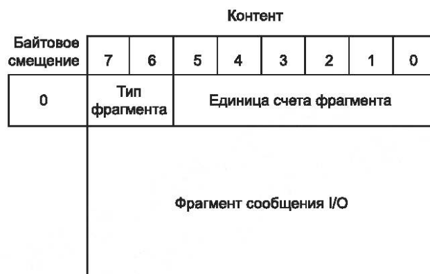
Рисунок 18 — Формат фрагмента сообщения I/O
