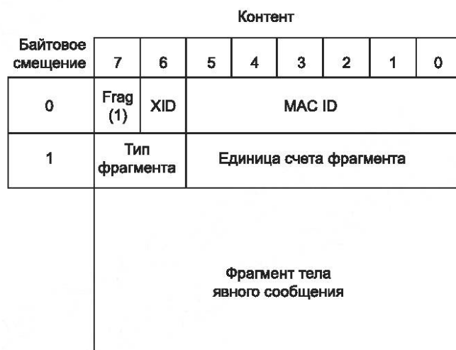
Рисунок 19 — Формат фрагмента явного сообщения
