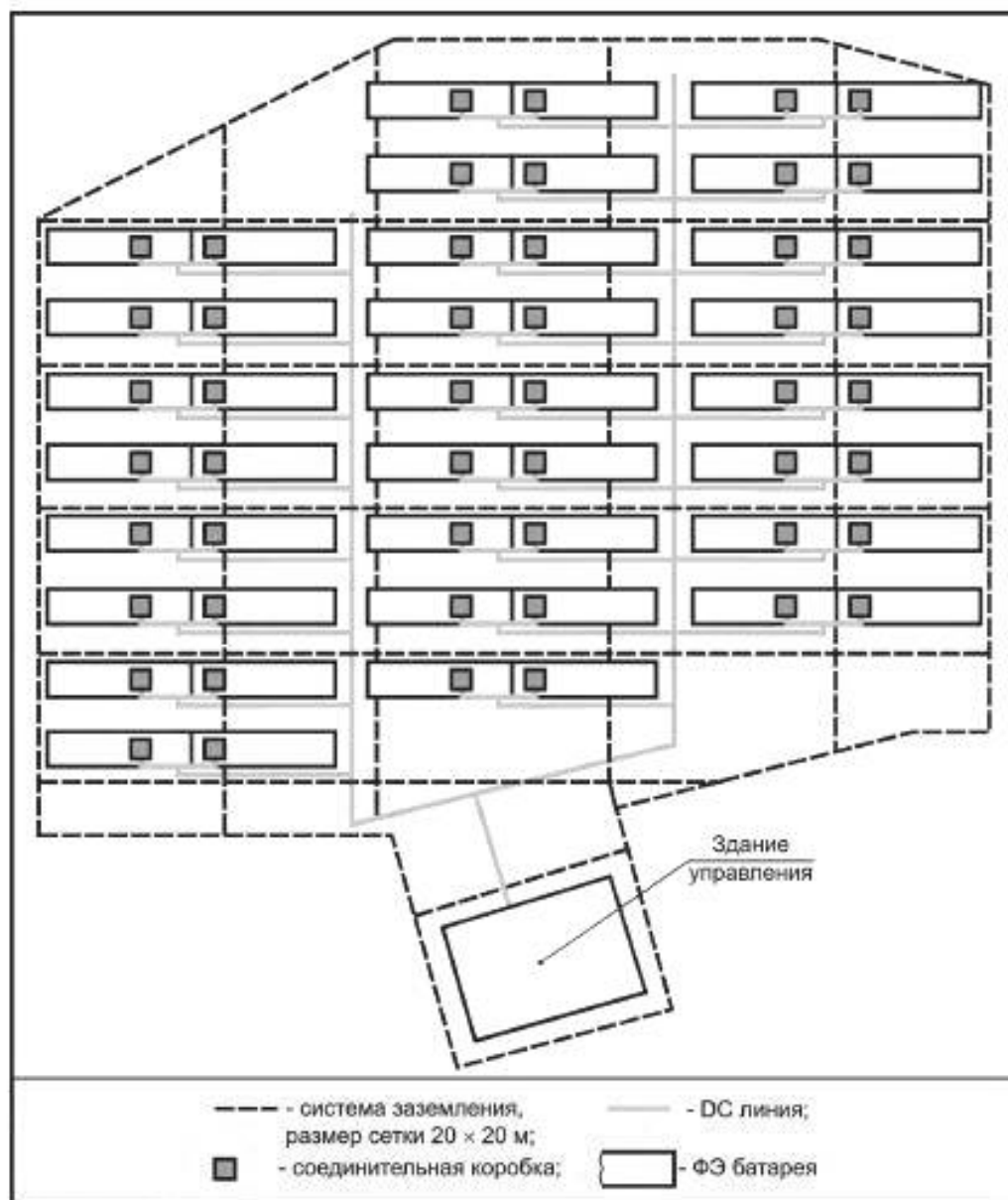
Рисунок А.2 — Пример структуры крупной ФЭС, размещенной на земле. Фотоэлектрическая солнечная электростанция с заземлением в нескольких местах и с заземляющим устройством в виде сетки
