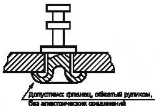
Рисунок 1 — Контакт с развальцованным фланцем
