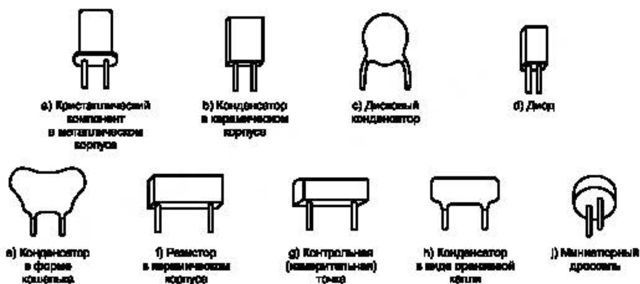
Рисунок А.2 — Типичная форма компонентов с двумя радиальными выводами
