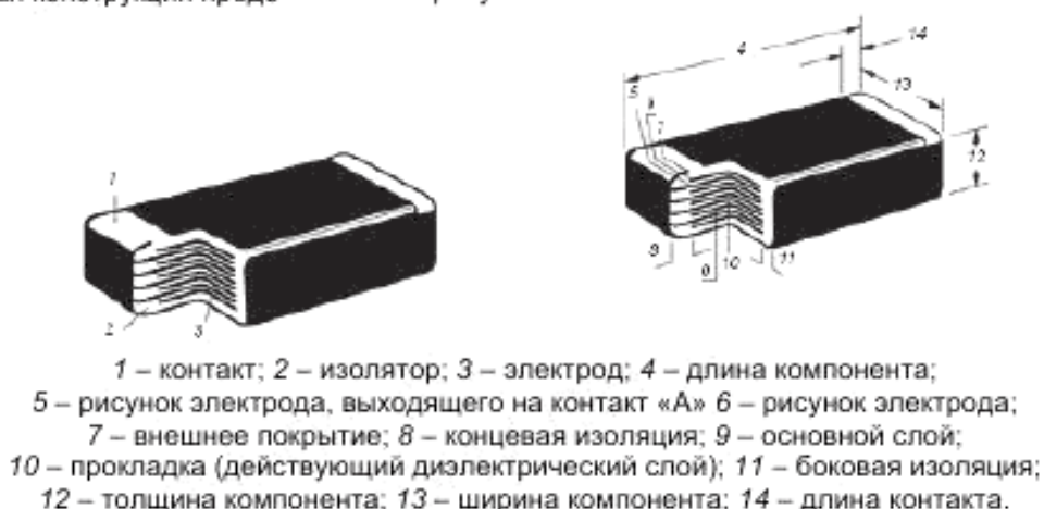
Рисунок 10 – Конструкция многослойного керамического безвыводного конденсатора
