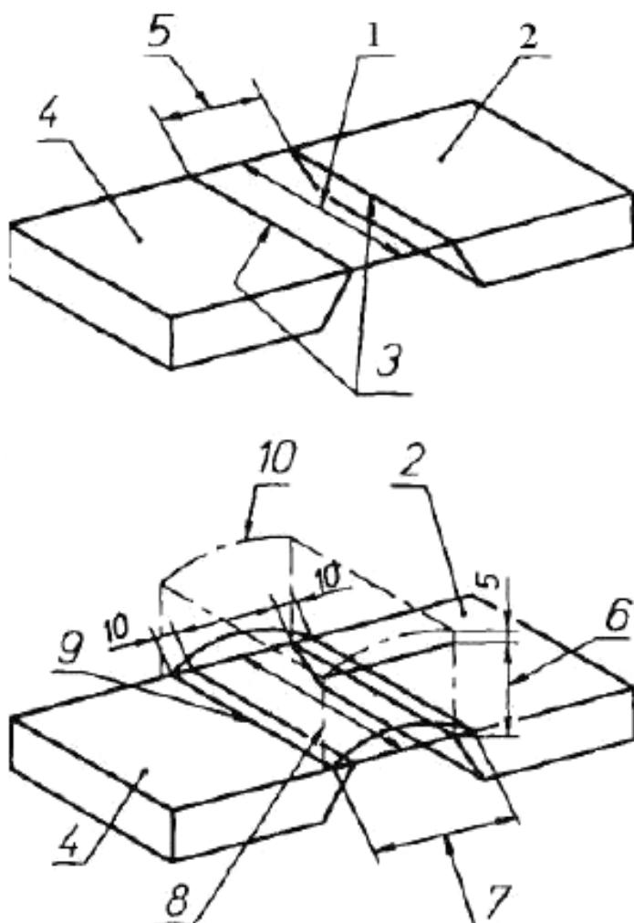
1 — ширина строгания; 2 — входной стол; 3 — края; 4 — выходной стол; 5 — ширина щели; 6 — высота деревянного изделия для максимально отрегулированного мостика; 7 — ширина мостика; 8 — длина мостика, предназначенная для закрывания ножей; 9 — мостик плоско прилегает к столу; 10 — мостик отрегулирован на максимальную высоту
