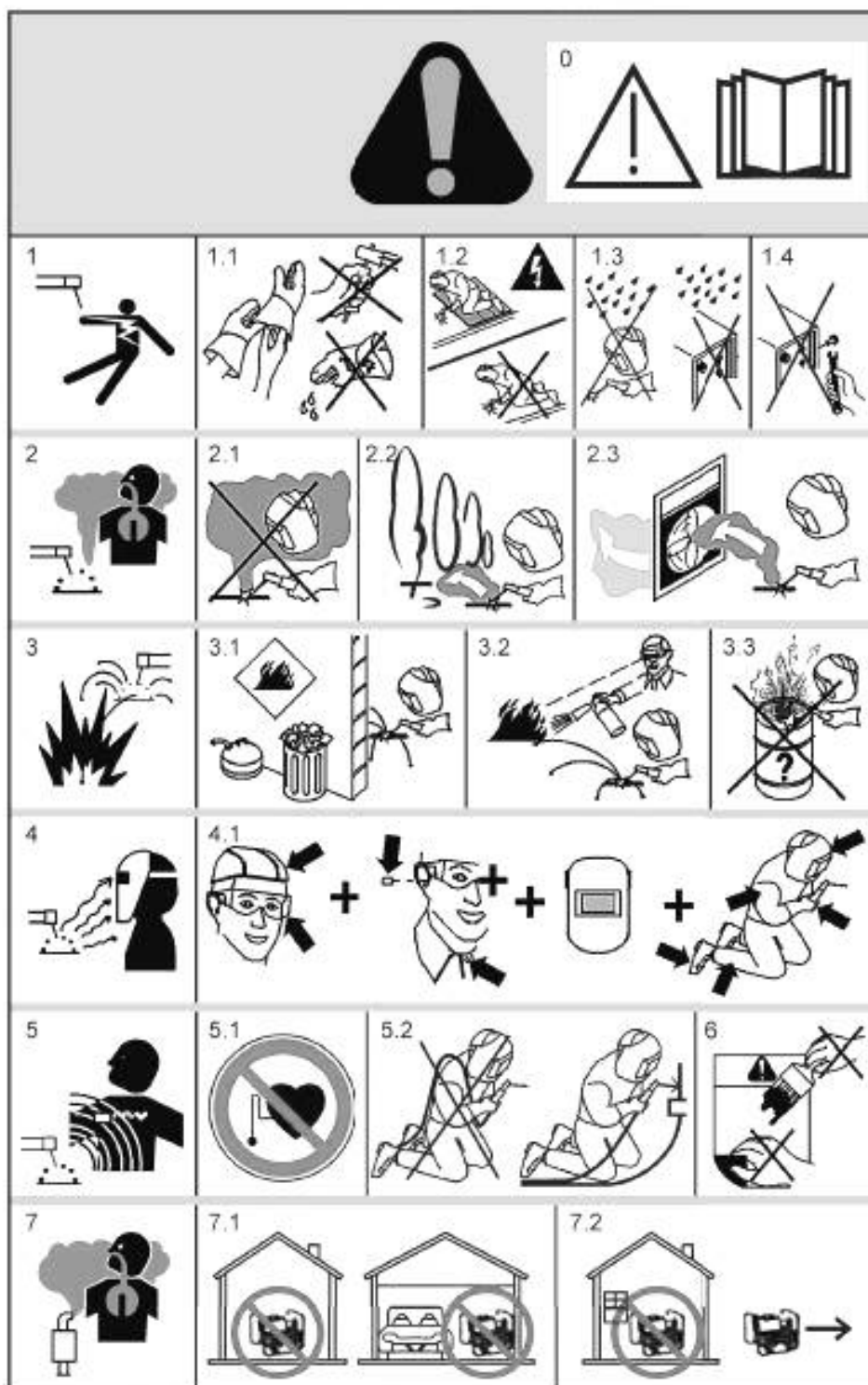
Рисунок С.1 — Пример предупреждающей таблички, устанавливаемой на источник тока с приводом от двигателя для дуговой сварки металлическим электродом
