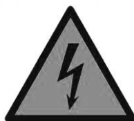
Рисунок О.1 — Маркировка электрических элементов с напряжением аккумулятора класса В
