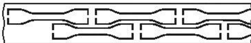
Рисунок 4 — Образцы, вырубленные ножом с выемкой
