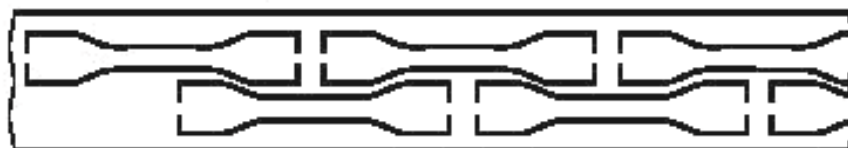
Рисунок 15 — Образцы, вырубленные ножом с выемкой
