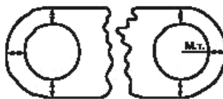
Рисунок 11 — Измерение толщины оболочки (плоский кабель с разделенными жилами)
