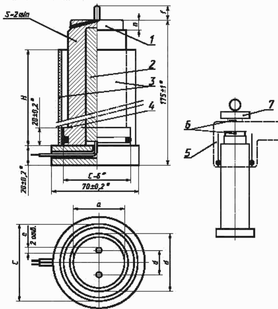
*H* — высота в соответствии с инструкциями изготовителя; *1* — стальной испытательный цоколь; *2* — источник тепла (доступное пространство); *3* — защитная трубка (при необходимости); *4* — выступ для защитной трубки; *5* — патрон; *6* — термометры; *7* — груз массой 100 г
