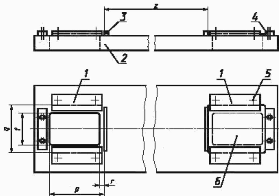
1 — зажимная скоба\*, перекрывающая монтажную пластину на 10 мм; 2 — опоры; 3 — упор; 4 — планка для прижима монтажной пластины к упору; 5 — винты крепления зажимной скобы; 6 — монтажная пластина (см. рисунок 2)
