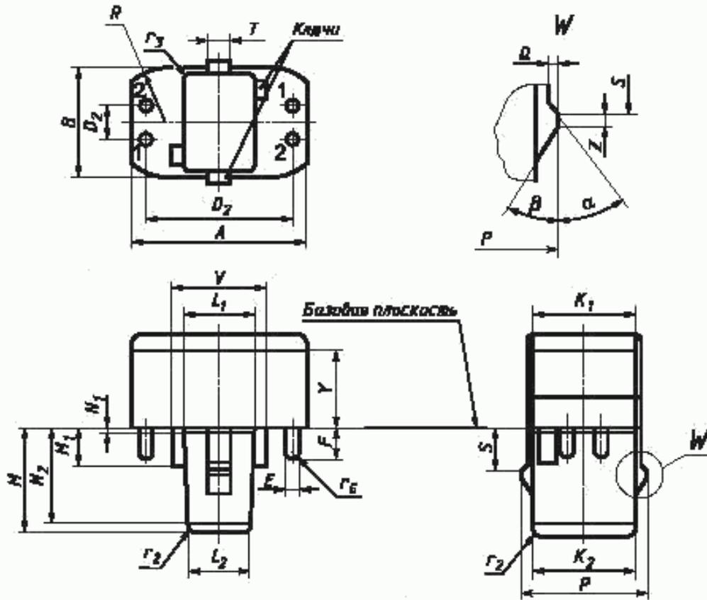
Штырьки 1 должны быть удалены при испытании патронов G32d-1 — G32d-5, GX32d-1 — GX32d-5, штырьки 2 — при испытании патронов GY32d-1 — GY32d-5.
