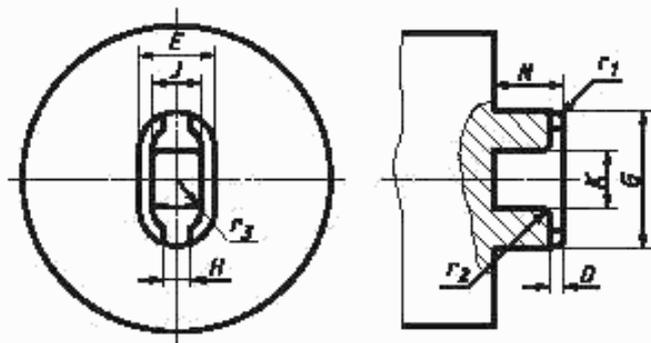
Рисунок 22 — Испытательный цоколь для испытания патронов R17d по разделу 13
