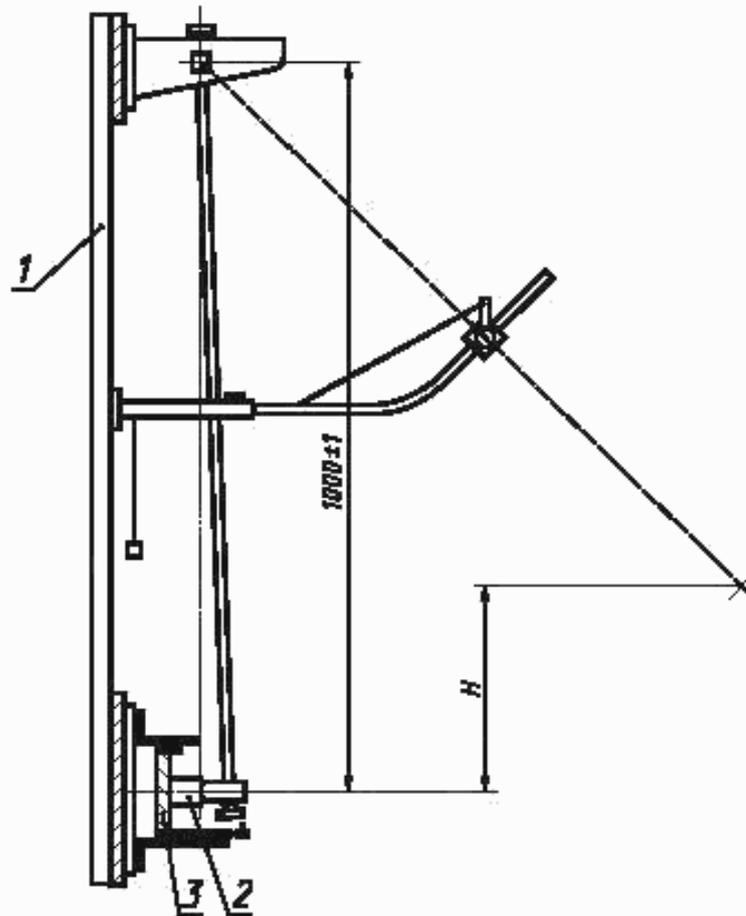
1 — рама; 2 — образец; 3 — монтажная пластина;  $H$  — высота падения
