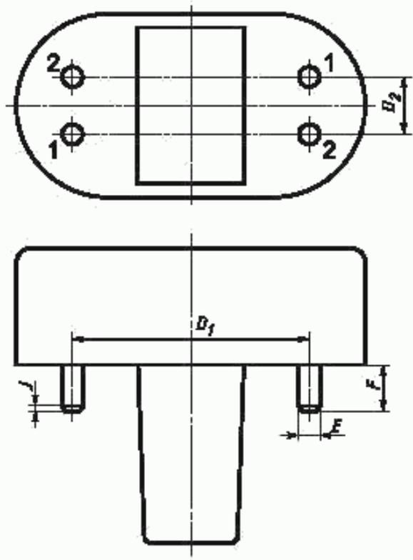
Штырьки 1 должны сниматься при испытании патронов G32d-1 — G32d-5, штырьки 2 — при испытании патронов GY32d-1 — GY32d-5.
