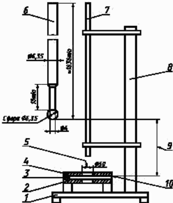
1 — основание; 2 — стальная нижняя пластина размером  $6,35 \times 150 \times 150$  мм; 3 — фибровый картон; 4 — верхняя стальная пластина размером  $20 \times 150 \times 150$  мм; 5 — отверстие; 6 — проникающий ударник массой 0,25 кг; 7 — направляющая труба с допусковым направлением от вертикального положения  $\pm 2^\circ$ ; 8 — стойка; 9 — высота падения; 10 — добавленная экстра крафт-бумага
