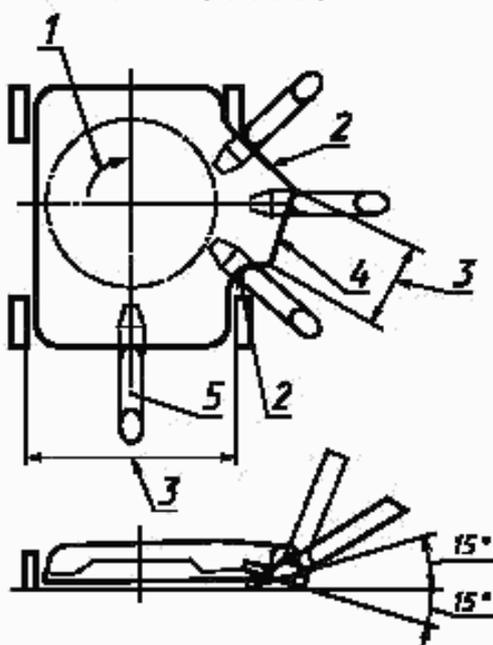
1 — направление вращения; 2 — сторона разгружающего спуска, которую проверяют испытательным пробником, если она менее чем на 3 мм ниже плоскости траектории лезвия; 3 — область, проверяемая испытательным пробником; 4 — разгружающее отверстие; 5 — испытательный пробник в виде стопы (или основание пробника из любого указанного начального положения)
