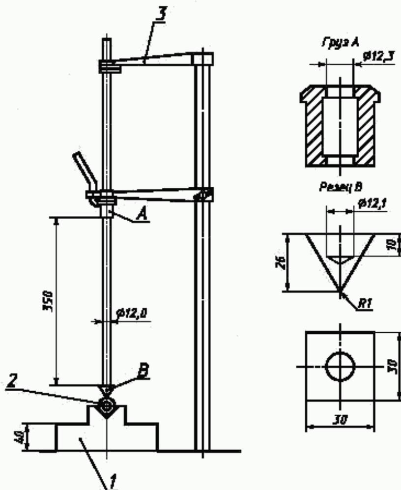
1 — основание массой 10 кг; 2 — образец; 3 — фиксирующий кронштейн
