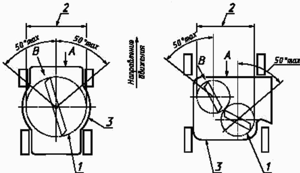
Рисунок 102 — Границы переднего отверстия одношпиндельных косилок
