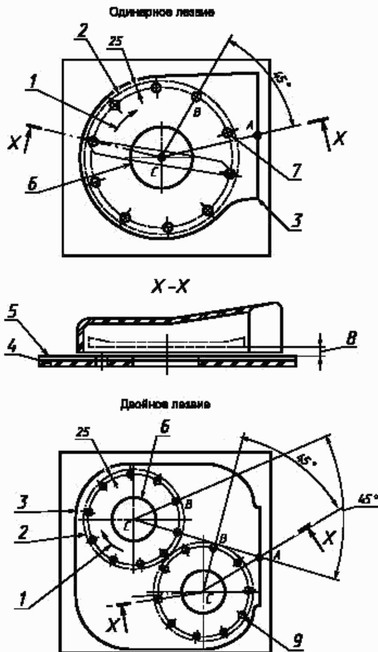
1 — направление вращения; 2 — траектория лезвия; 3 — отражение лезвия; 4 — фанера; 5 — стальная лицевая сторона; 6 — отверстие для входа воздуха; 7 — десять отверстий инжектирования диаметром 15 мм, расположенные через равные промежутки; 8 — высота резания; 9 — десять отверстий инжектирования диаметром 15 мм, расположенные через равные промежутки для каждого шпинделя
