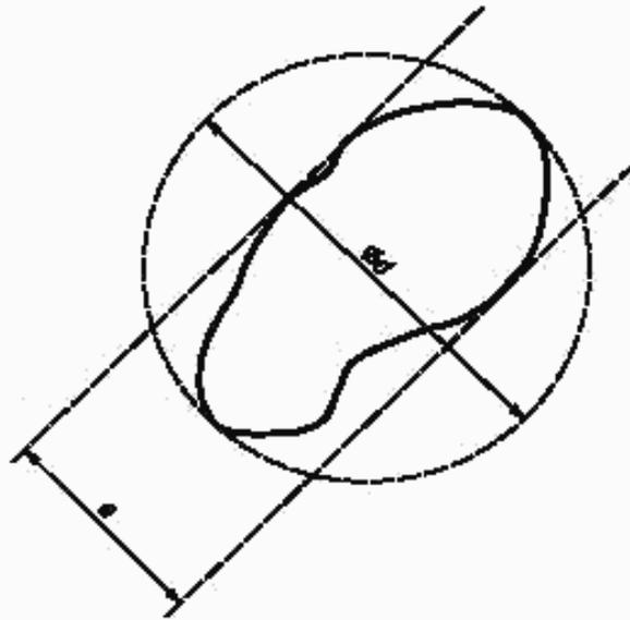
Рисунок АА.1 — Определение стандартного отверстия
