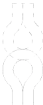
Положение шланга в начале и конце каждого изгиба Рисунок 104 – Положения изгиба для шланга после извлечения из морозильного шкафа
