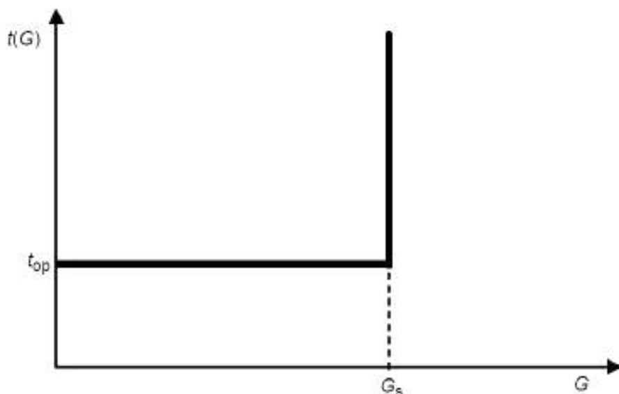
Рисунок 3 — Независимая характеристика времени реле недостаточного напряжения
