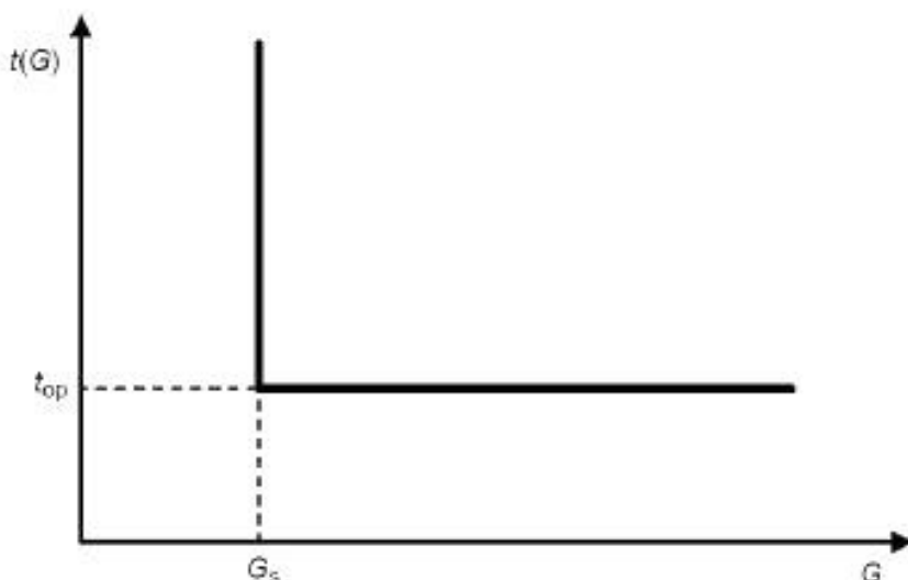
Рисунок 2 — Независимая характеристика времени реле сверхнапряжения
